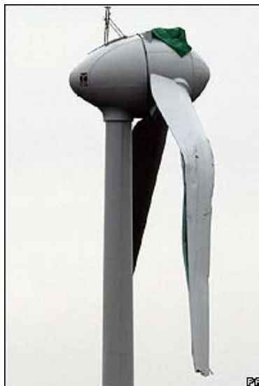
La turbina apareció a primera hora del domingo sin una de sus palas de 20 metros.
